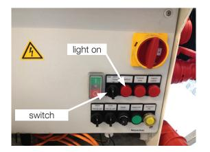
Indicator light «Wasserdruck» (water pressure) lights.
