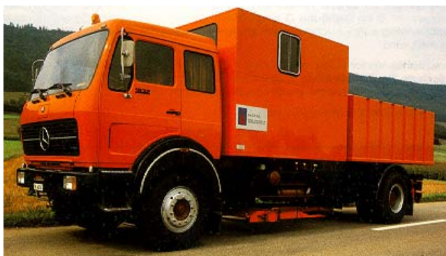
Bilder 7/8: Lacroix Messwagen und Messbalken in Aufnahmestellung
