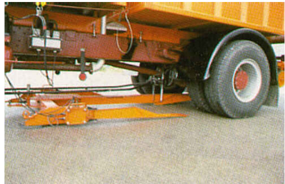
Photos 7/8 : Véhicule de mesures Lacroix avec poutre de mesure en position d'enregistrement
