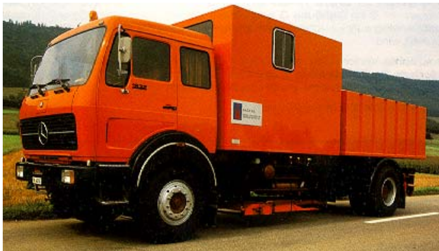
Photos 7/8 : Véhicule de mesures Lacroix avec poutre de mesure en position d'enregistrement
