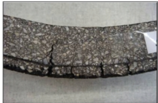
Photo 3 : Essai avec couche S&P Carbophalt G 200 kN
